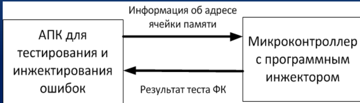
Структура системы для инжекции ошибок
