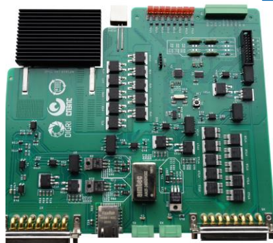
Внешний вид одноканального модуля организации питания
