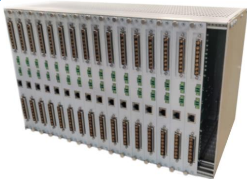
Внешний вид 16 канального блока организации питания (БОП)
